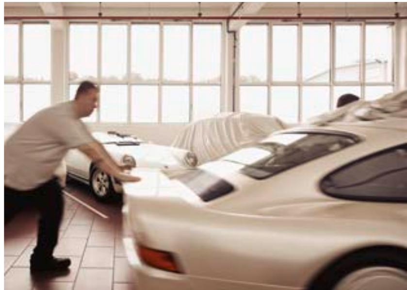
TECHNOLOGIETRÄGER: DER PORSCHE 959 GRUPPE B STUDIE, BAUJAHR 1983, MIT 450-PS-BOXERMOTOR, WASSERGEKÜHLTEN ZYLINDERKÖPFEN UND BITURBO-REGISTERAUFLADUNG, ELEKTRONISCH GEREGELTEM FAHRWERK, ALLRADANTRIEB UND AERODYNAMISCH OPTIMIERTER KAROSSERIE.
